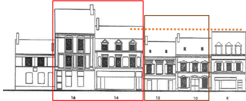
Variation des hauteurs d'étages et des combles : hauteur RDC+2+combles Hauteur RDC+1+combles = hauteur RDC+2+combles
